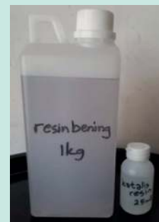
Gambar 3.3 Bahan resin dan katalis yang akan digunakan bersama fiberglass Sumber : Kemdikbudristek/Dewi
