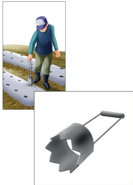
Gambar 1.7 Ceplongan untuk melubangi mulsa sesuai jarak tanam.
